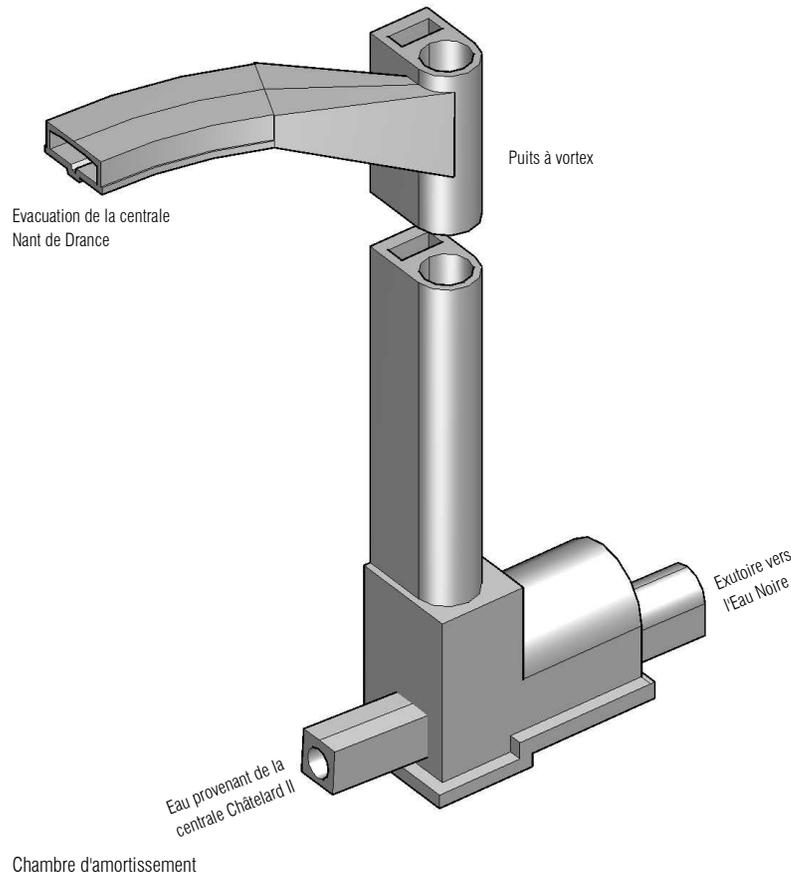
En cas d'avarie de la centrale souterraine de Nant de Drance, les eaux sont évacuées par le tunnel d'accès à la centrale, puis par un canal rectangulaire, aménagé sous la route d'accès. Dès le portail du tunnel, situé à environ 40 m plus haut que l'exutoire envisagé, le canal d'évacuation est dirigé vers un puits à vortex.
